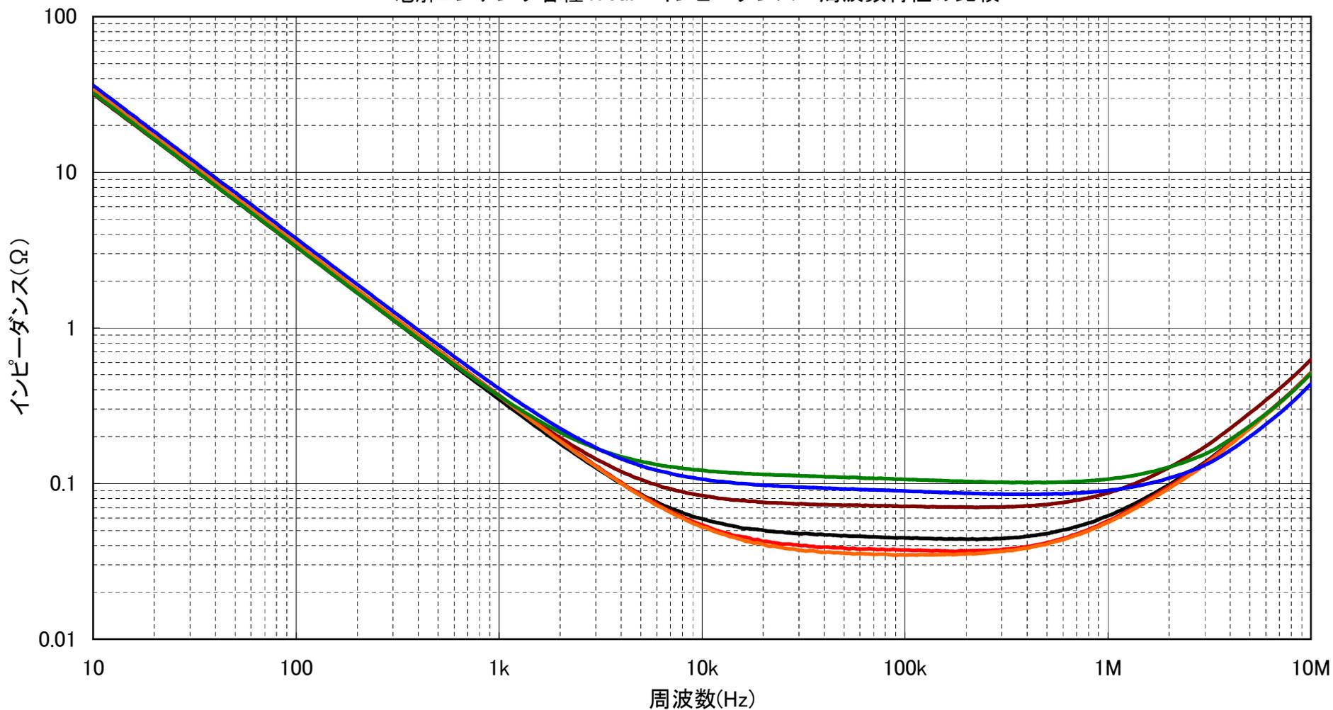
— KY25V470uF — LXY16V470uF — LXZ35V479uF — ROD35V470uF — SMG35V470uF — YK25V470uF
