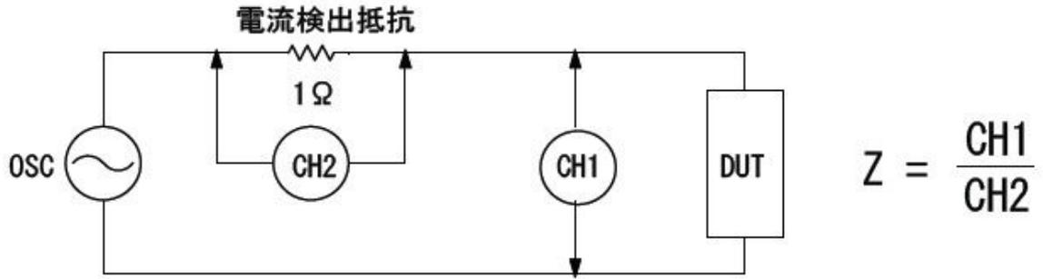
スイープ発振器出力を被計測体に接続し、電流と電圧からインピーダンスを算出する。
