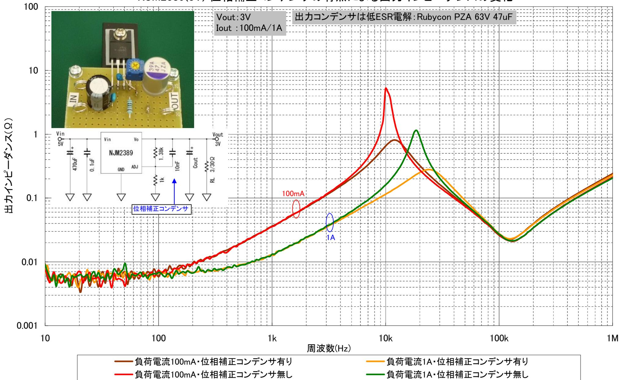
NJM2389 (出力電圧 3V) 位相補正有無による負荷電流変動時のリングング
