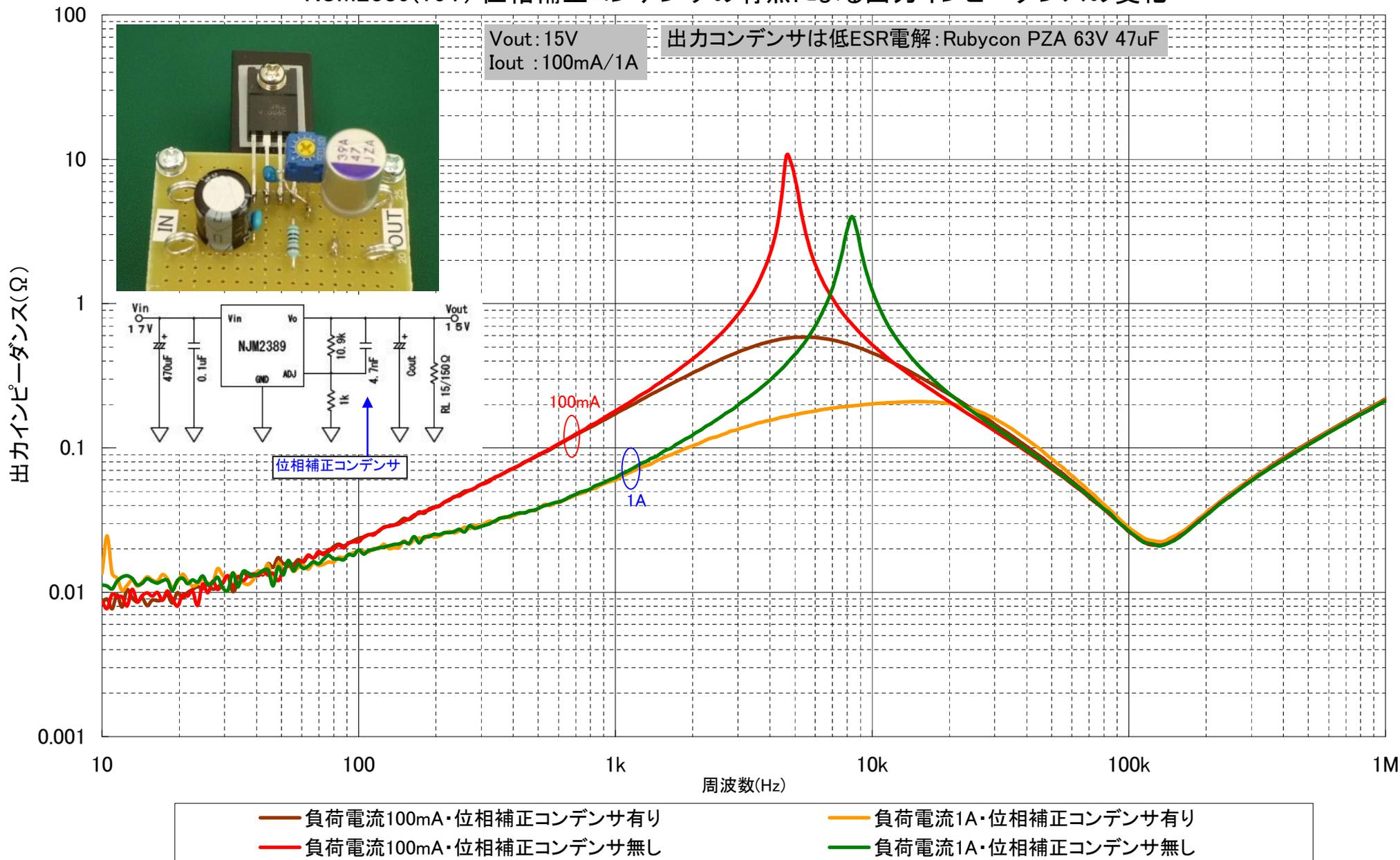
NJM2389 (出力電圧 15V) 位相補正有無による負荷電流変動時のリンギング
