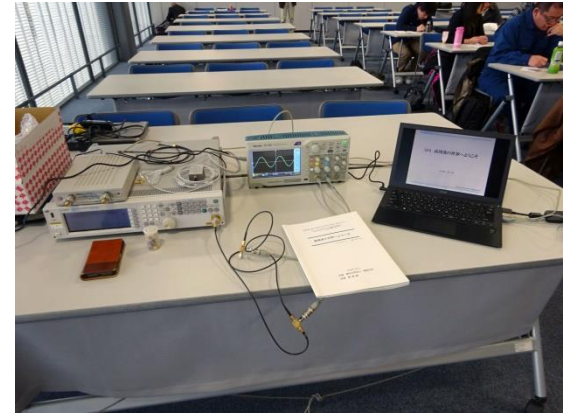
A04 高周波回路測定デモ装置
